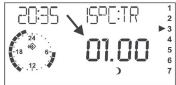
Nota: Durante el tiempo establecido como desconexión, el circuito de calefacción se regula a las temperaturas configuradas para el funcionamiento 🌙 reducido
